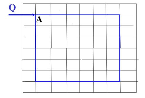
Definição do ponto (A) de alimentação do anel, por canalização que vem de reservatório, aduzindo vazão Q.
