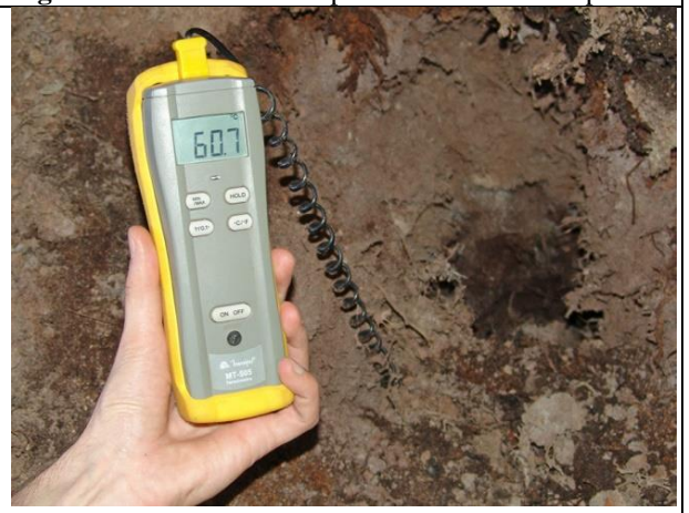
Figura 13.5: Controle da temperatura nas leiras de compostagem
