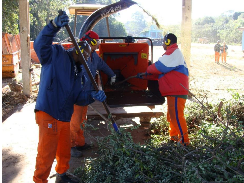
Figura 13.14: Triturador para resíduos de poda, no pátio de compostagem do DMLU, em Porto Alegre.
